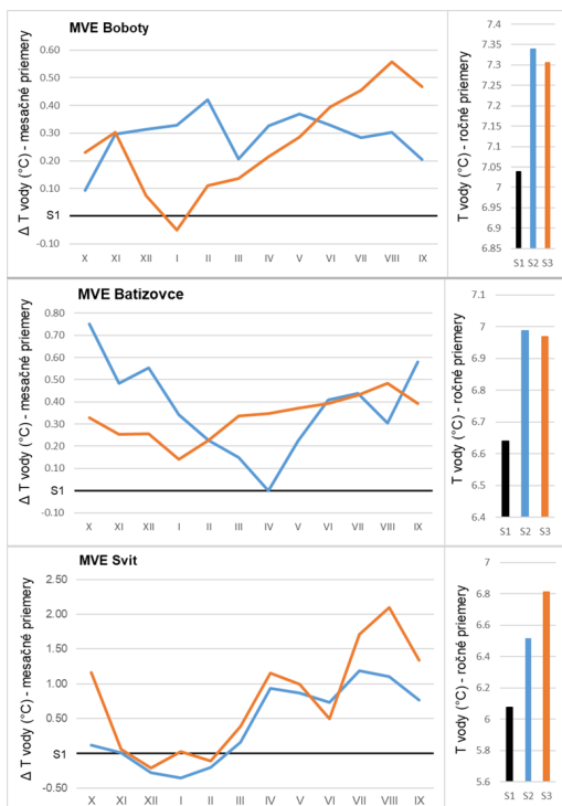
Obr. 2. Zmena priemernej mesačnej teploty vody na lokalitách v zdrojovom koryte (S2, modrá) a pod MVE (S3, oranžová) v porovnaní s lokalitou S1 (čierna) nad MVE.
